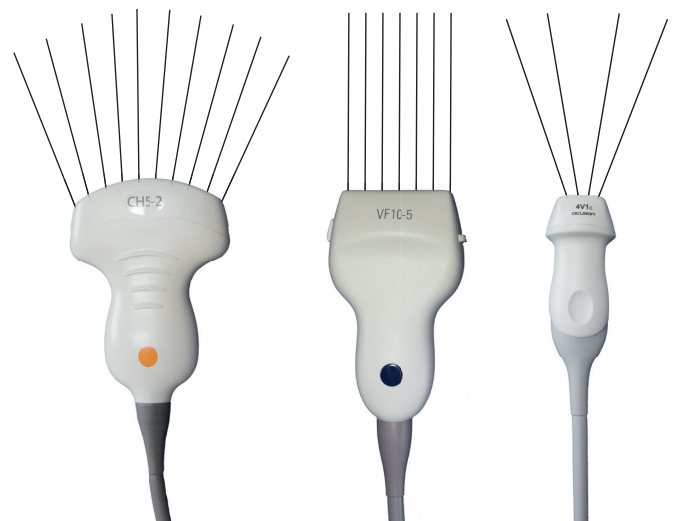
Abb. 2: Konvex-, Linear- und Sektorschallkopf mit Ausbreitung der Schallwellen
